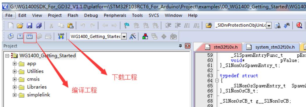
这样程序就下载到评估板中去了，接下来可以测试一下板子的功能
